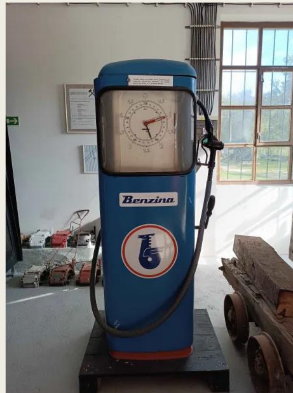
Výdejní stojan na pohonné hmoty používaný při tankování diesellových lokomotiv
